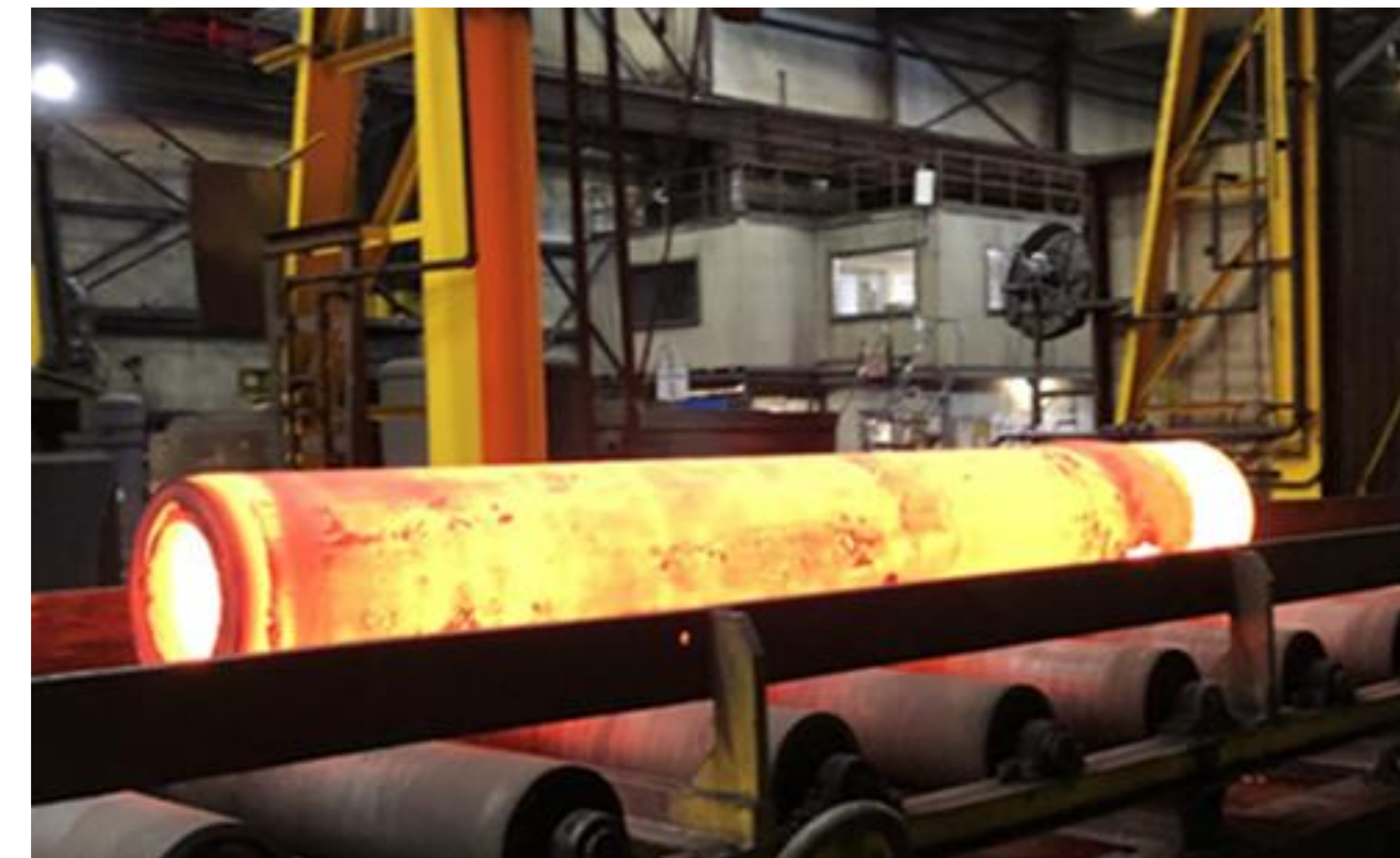
22” OD x 3.7” W pipe extruded at Wyman-Gordon, Houston TX
